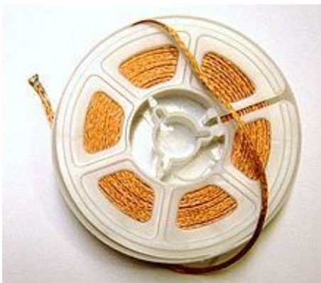
그림 6 땀납제거용 구리심지(왼쪽), 땀납제거 전(오른쪽 위)과 후(오른쪽 아래)의 심지 형상
